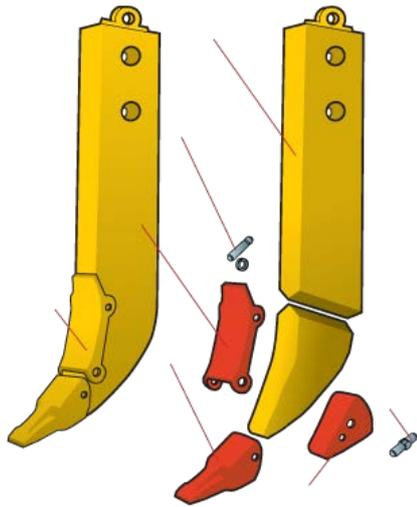
стойка защитная, накладка, стопорное устройство, насадка, наконечник, зуб рыхлителя в сборе, стопорное устройство.
