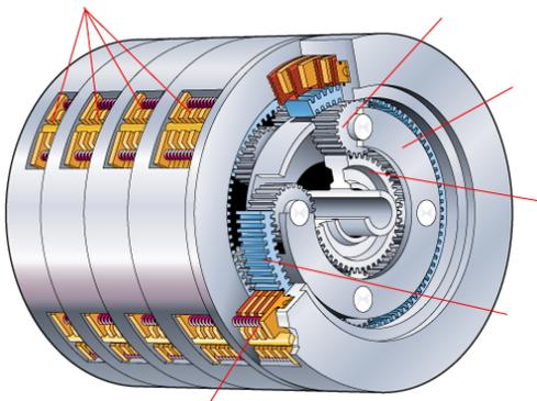
водило, сателлит, коронная шестерня, фрикционные диски, солнечная шестерня, пакет муфты.
