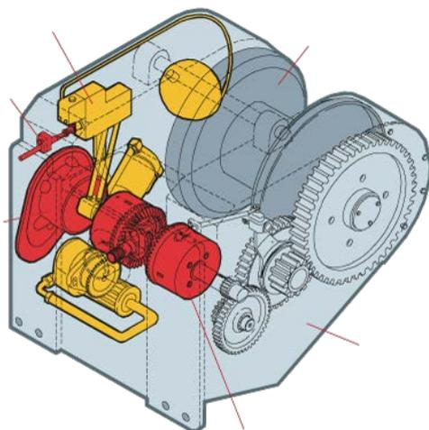
многодисковая муфта, гидравлический тормоз, рычаг управления, гидравлический суппорт, барабан, корпус лебедки.
