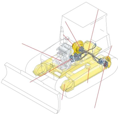
двигатель, гидронасос, гидромотор, конечная передача, направляющее колесо, поддерживающий каток, рукава высокого давления (рвд), планетарный редуктор, звездочка.
