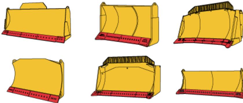
неповоротный отвал, амортизирующий отвал, u-образный (универсальный) отвал, поворотный отвал, полу u-образный отвал, угловой поворотный отвал.
