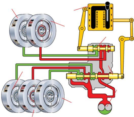
муфта заднего хода, муфта переднего хода, переключатель передач, золотник клапана, клапан скоростного диапазона, гидравлический насос, муфта первой передачи, муфта второй передачи, муфта третьей передачи.
