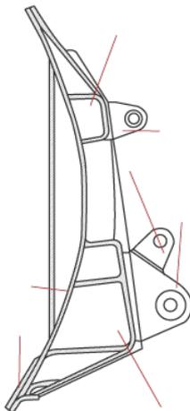
сменный нож, лобовой лист, верхняя коробка жесткости, проушина раскоса, проушина гидроцилиндра, проушина толкающего бруса, нижняя коробка жесткости.
