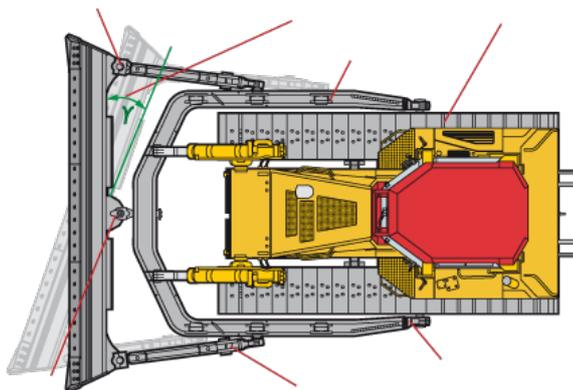
угол отклонения, гусеничная лента, упряжной шарнир, крестовина, толкающая рама, боковой толкатель, центральный шаровый шарнир.
