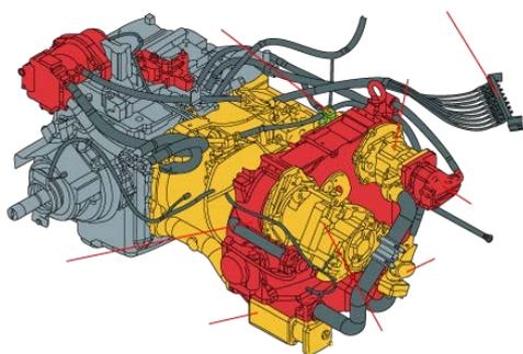
сетчатый фильтр, разгрузочный клапан, гидронасос трансмиссии, штуцеры измерения давления масла, гидронасос рулевого механизма, откачивающий насос, гидронасос системы управления, гидротрансформатор.
