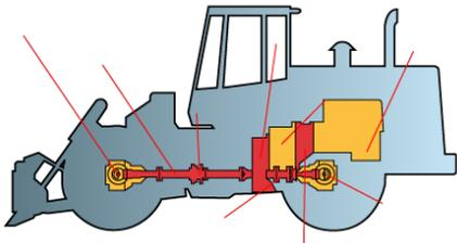
передний мост, карданная передача, универсальная муфта, коробка передач, гидротрансформатор, задний мост, дизельный двигатель.
